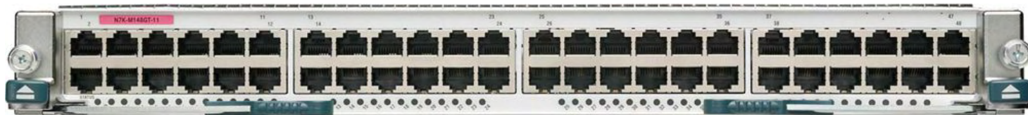
Figure 1-8. Nexus 7000 M1-48 10/100/1000 Ethernet Module
